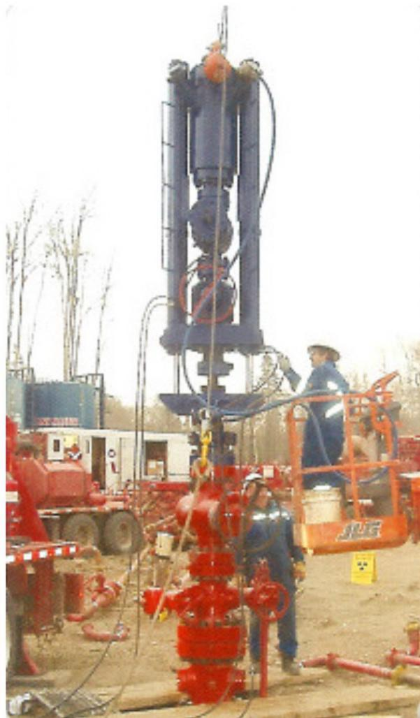
В зависимости от диаметра лифтовой колонны и высоты фонтанной арматуры подбираются шток полый, насадки, удлинительные вставки и собираются с переходником, образуя центральный ствол.
