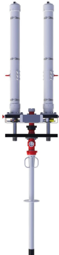
Протектор фонтанной арматуры (АФП-06) [предназначен для защиты фонтанной арматуры от высокого давления при технологических работах на газовых и нефтяных скважинах, связанных с закачкой в пласт \(гидроразрыв пласта, обработка призабойной зоны и т.д.\).](#)
